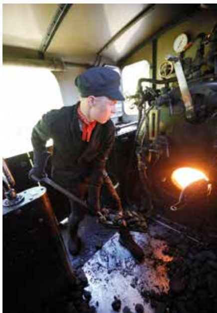
La mission du chauffeur: alimenter le foyer en charbon et la chaudière en eau.
